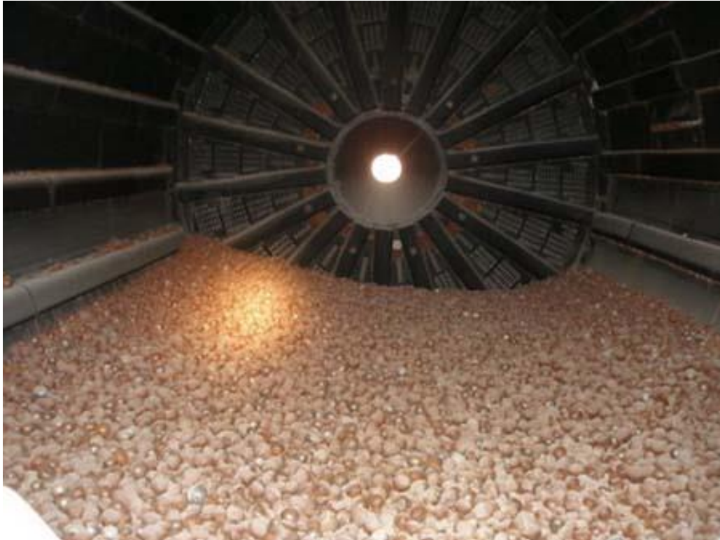
Fig. 30 Moinho de bolas, operação unitária usada na preparação de pós cerâmicos (metodologia top-down )
