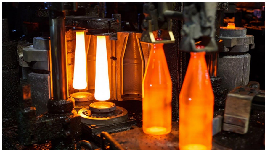
Fig. 26 Fabrico automático de vidro de embalagem: máquinas IS soprado-soprado (a) e (b) (a)
