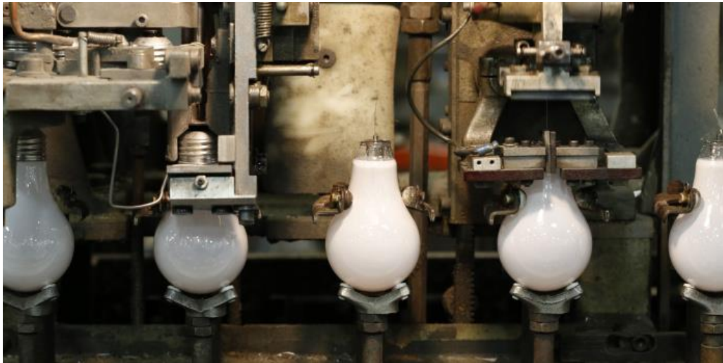
Fig. 36 Fabrico de vidros especiais: lâmpadas(a) e fibras óptica (b)
