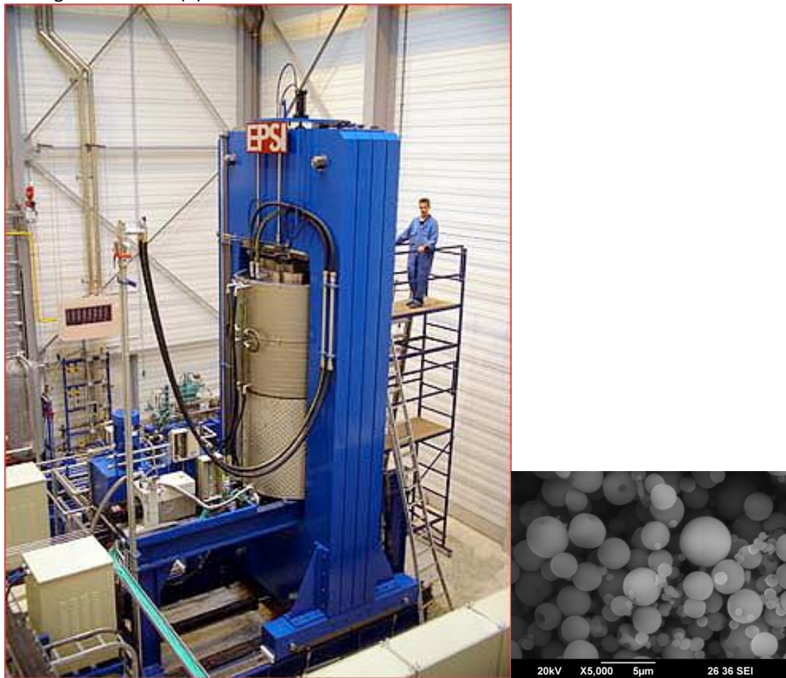
Fig. 32 Operações unitárias do fabrico de cerâmicos por via seca: atomizador ( spray-drying ) (a); prensagem isostática (b)
